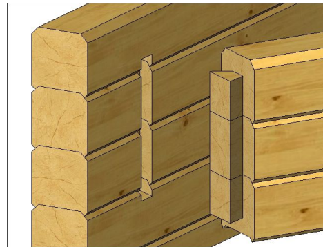
Соединение "ласточкин хвост" на брус, с зазором сверху на верхнем бревне и с зазором снизу на нижнем бревне
